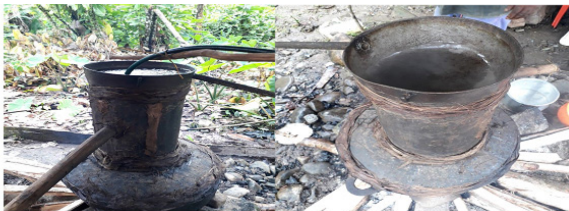
Figura 2. Elemento elaborado artesanalmente por productores para el proceso de destilación.
